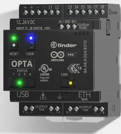
**Descrizione tecnica:** Opta - Programmable Logic Relay, PLR, 4 uscite, 10 A, Tipo di alimentazione DC, tensione di alimentazione nominale 24 V, funzionamento da 10.2 a 27.6 V, N° of input: = 8 digital/analog input, Contatti NO (SPST) - EMR, Versione Lite, USB (porta di tipo C) e RJ45, temperatura ambiente da -20 a +55 °C
