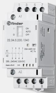
**Descrizione tecnica:** Contattore modulare, 25 A, 4 contatti, NO, 25 A, AgSnO2, Bobina AC/DC, 230 V, funzionamento da 184 a 264 V (AC) e da 176 a 242 V (DC), potenza nominale 2 VA (AC) / 2.2 W (DC), tensione di mantenimento 92 V (AC)/(DC), tensione di rilascio 23 V (AC)/(DC), variante: Selettore manuale + indicatore meccanico + LED, temperatura ambiente da -25 a +50 °C
