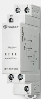
**Descrizione tecnica:** Relè elettronico, Bistabile modulare, fissaggio su barra 35 mm (EN 60715), larghezza 17.5 mm, 1 contatto, 12 A, Tipo di alimentazione AC, tensione di alimentazione nominale 230 V, funzionamento da 0.8 a 1.1 V, potenza nominale 1.7 VA, AgCdO, Circuito contatti: scambio, temperatura ambiente da -10 a +60 °C
