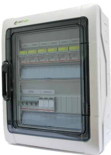
**Quadri di campo**, composti da portafusibili 2P con fusibili con tensione nominale di esercizio pari a 1000 VDC, interruttori sezionatori sottocarico con tensione nominale da 600/800/1000 VDC, scaricatori di sovratensione di Classe II con corrente di scarica massima  $I_{max}$  40 kA.
