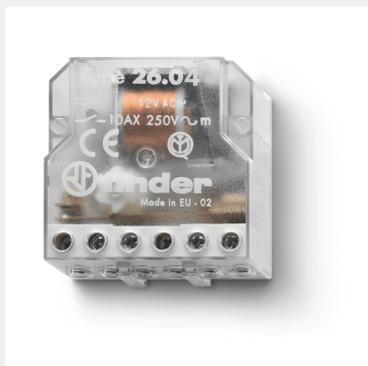
**Descrizione tecnica:** Stromstoßrelais, Da incasso terminali a vite, Commutatore 4 sequenze 2 NO, 10 A, Bobina AC, 230 V, funzionamento da 184 a 253 V, potenza nominale 4.5 VA, resistenza 6250  $\Omega$ , assorbimento 20 mA, temperatura ambiente da -40 a +40 °C
