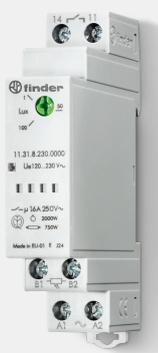
**Descrizione tecnica:** Relè crepuscolare, Montaggio su barra DIN 35 mm, larghezza 17.5 mm, 1 contatto, 16 A, Variante: standard, Tipo di alimentazione AC, tensione di alimentazione nominale 230 V, funzionamento da 90 a 265 V, potenza nominale 2.5 VA, temperatura ambiente da -20 a +50 °C
