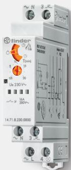
**Descrizione tecnica:** Temporizzatore luce scale, Fissaggio su barra 35 mm (EN 60715), 3 funzioni, 1 contatto, 16 A, Tipo di alimentazione AC, tensione di alimentazione nominale 230 V, funzionamento da 184 a 253 V, potenza nominale 3 VA (AC) / 1.2 W (DC), temperatura ambiente da -10 a +60 °C
