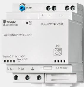
**Descrizione tecnica:** Alimentatore switching, uscita 60 W, Uscita 24 V, Standard, Fusibile integrato + regolatore tensione di uscita, Entrada AC/DC (no polarizada), salida DC, tensione di alimentazione nominale 230 V, funzionamento da 88 a 265 V (AC) e da 140 a 370 V (DC), temperatura ambiente da -20 a +70 °C
