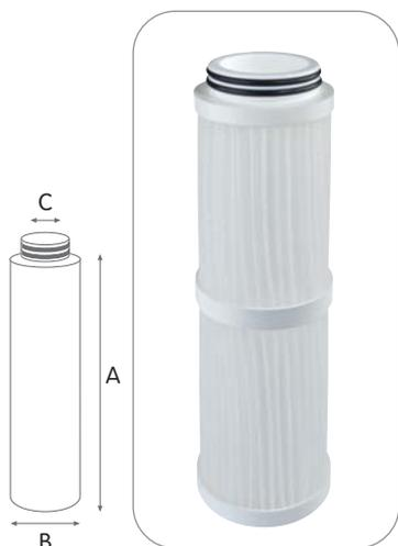
Le cartucce in rete lavabile di polipropilene con filtrazione nominale 50 micron sono progettate per fornire un'elevata portata con basse perdite di carico. Le cartucce RS offrono un'ampia superficie filtrante. Altezza 10" e 20".
