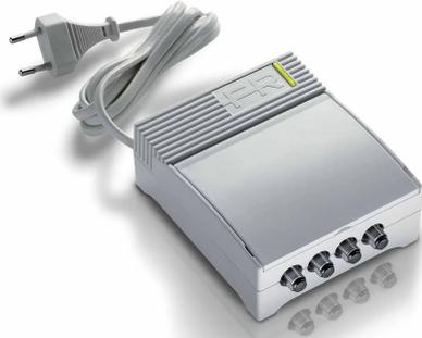
Amplificatore da interno autoalimentato con 1 ingresso (VHF+UHF) e 2 uscite con guadagno 30dB e livello di uscita fino a 106dB $\mu$ V in banda UHF, regolazioni del livello indipendenti (15/20 dB) per ogni banda e bassa figura di rumore.
