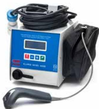
La saldatrice modello Euro Midi è una macchina polivalente idonea alla saldatura di tutti i raccordi elettrosaldabili fino al diametro d. 400. Consente all'operatore di lavorare con tensione antinfortunistica inferiore a 50 Volt ed è stata costruita in conformità alle norme UNI 10566 e ISO 12176-2, nonché provvista di marchio CE.
